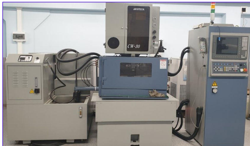
Электроэрозионный проволочно-вырезной станок погружного типа CW-30
