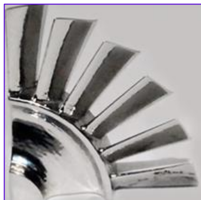
Внешний вид моноколеса с лопатками (блиска) до и после СЭП
